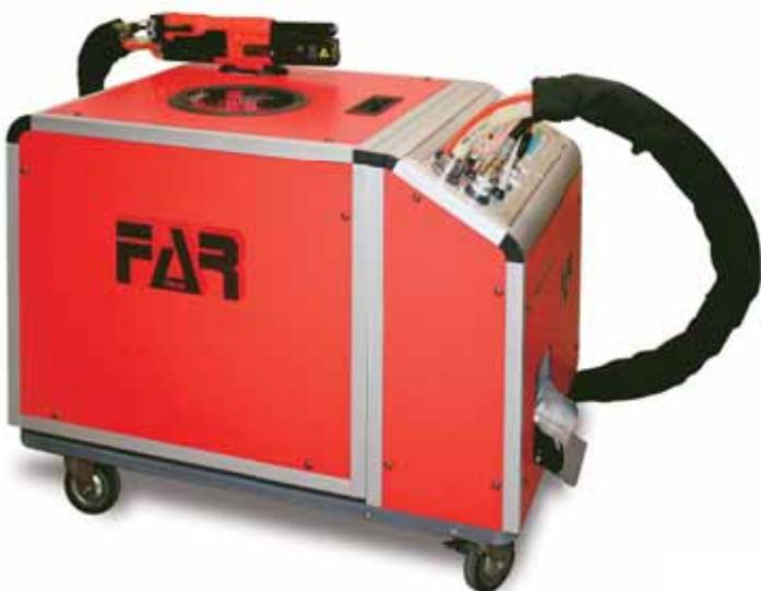
Rivettatrice con alimentazione automatica del rivetto a strappo disponibile per rivetti da Ø 3,2 mm a Ø 5,0 mm in tutte le leghe e Ø 6,0 mm solo in lega di alluminio. La macchina viene fornita attrezzata per una sola misura di rivetto a richiesta del cliente, per l'eventuale cambio di formato, verrà fornito il kit adeguato alla misura occorrente.
